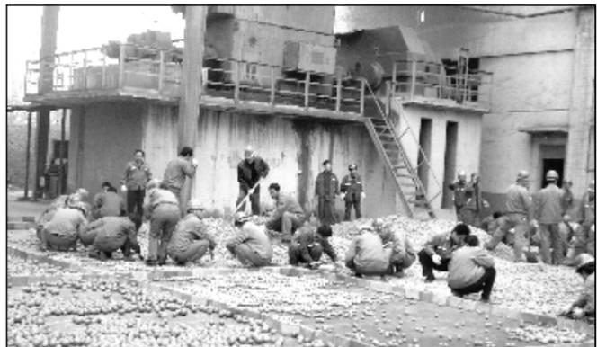
近日,为有效提高水泥磨台产,水泥厂及时调整生产计划,组织机关人员对水泥磨进行停磨钢球级配,按大、中、小、废四个不同类别堆放,节约万余元检修费用,有效降低了成本。摄影报道 水泥厂
