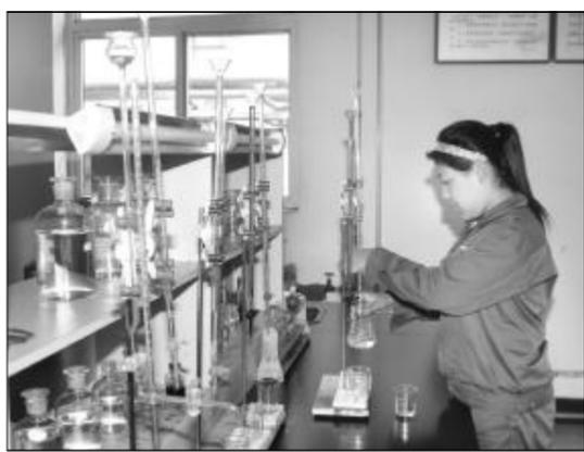
晋铝铝业冶金材料余热电站化水车间主要负责检验锅炉的给水品质,检测给水的酸度、硬度、碱度等指标,为锅炉提供合格的除盐水,使锅炉系统减少水垢形成。据悉,水垢形成将会导致锅炉受热不均匀,降低热效率,增加能耗,影响锅炉安全稳定运行。图为工作人员正在检测给水品质。摄影报道 本报记者 芦莲莲
