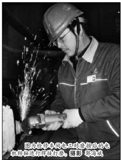
图为检修车间电工对磨损后的电机转轴进行焊接打磨。摄影 郭海斌
